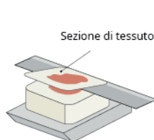
Utilizzando una lama da sezionamento, si ottiene una sezione di tessuto dello spessore specificato. Contemporaneamente, la sezione di tessuto viene fissata al nastro di supporto in tempo reale.
