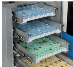
Unità di alimentazione a 96 blocchetti
