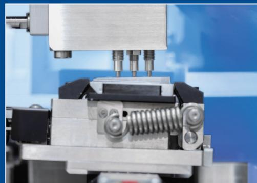
L'altezza e l'angolazione della superficie del blocco vengono regolate automaticamente
