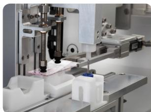
Al fine di evitare la formazione di bolle il vetrino coprioggetti viene depositato con un movimento particolare delle due ventose.
