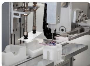
Il vetrino viene portato alla posizione di montaggio da un traslatore dotato di pinza e la colla di montaggio viene dispensata sulla sezione.
