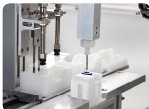
Il vetrino coprioggetti viene prelevato da due ventose mentre l'ago dispensatore si muove dalla posizione di stand-by ( boccetta di solvente ) alla posizione di dispensazione..
